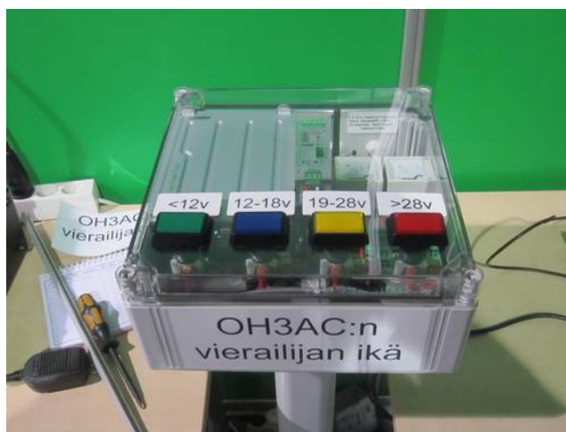
Kuva: Messuja varten Jarmon, OH3RP; ja Raimon, OH3RV; rakentama kävijämäärämittari
